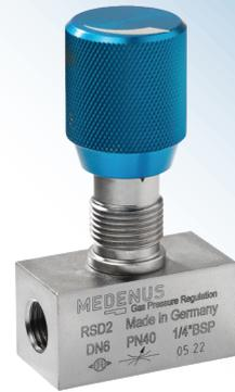
Das RSD2 ist ein Drosselventil, welches den Volumenstrom in der Messleitung durch eine stufenlose einstellbare Querschnittsverengung von außen beeinflusst. Die Einstellung erfolgt werkzeuglos mittels Drehknopf und kann durch eine Madenschraube fixiert werden. Das Drosselventil ist nicht komplett absperrbar, daher ist ein garantierter Mindestdurchfluss gesichert.
